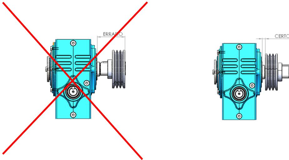
O uso de martelo na montagem desses elementos pode danificar os rolamentos e dentes das coroas e sem fim do redutor.
